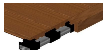
Schéma 6 : pose finition perpendiculaire (sur rail B)
