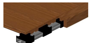
Schema 7 : plaatsing loodrechte afwerking (op rail B)
