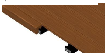
Schema 6 : plaatsing parallelle afwerkingen (op rail A)
